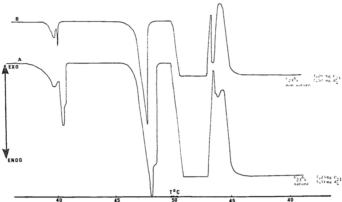
Fig. 9. Courbes ACD de l'alumine  $A_4$  saturée ou non en tricosane. Vitesses de chauffe et de refroidissement,  $6^\circ\text{C h}^{-1}$ .
